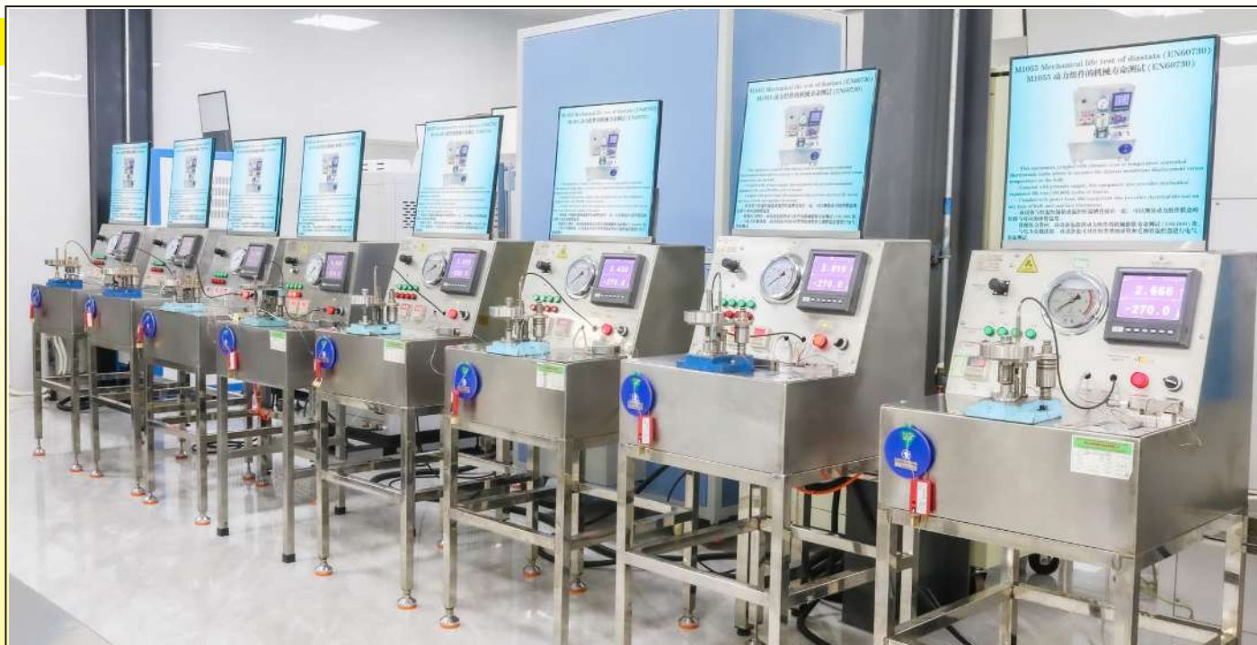
Reihe von mechanischen Lebensdauertestgeräten für Diastate Jedes Gerät ist mit einem Datenrekorder ausgestattet, der die Testparameter und die Anzahl der Zyklen aufzeichnet. (Ultimheat Labor)
